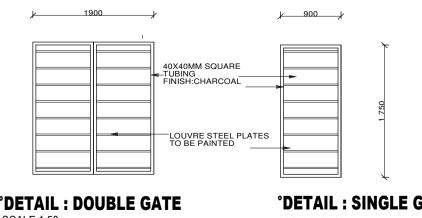
°DETAIL : DOUBLE GATE SCALE 1:50 **\*DETAIL : SINGLE GATE** SCALE 1:50
